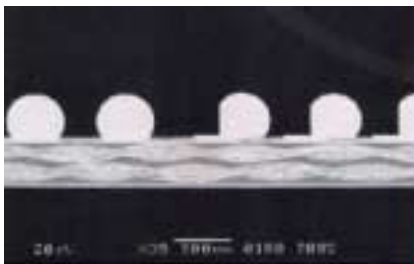
(Ni:10um, Au:1um, overresist:35um, bump diameter:0.25mm)
